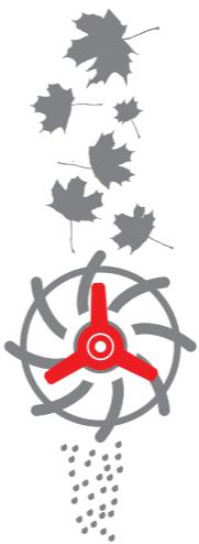
Воздуходувы с функцией всасывающего измельчителя оснащены трехлопастным стальным ножом, который превращает листву и небольшие ветки в мульчу.
